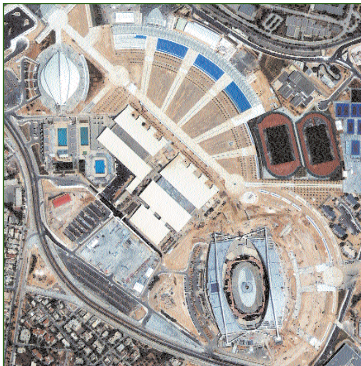
Рис. 1 Пример изображения со спутника QUICKBIRD с разрешением 0,60 м (Греция, Афины)
