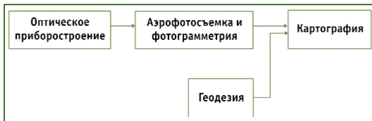
Рис. 1 «Технологический каркас» аэрофототопографии
